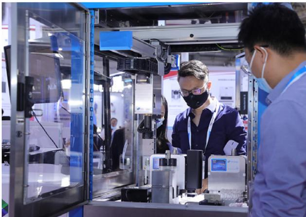
**2. CAMAG HPTLC PRO 全自动数字薄层色谱系统：**世界首创的全自动高效薄层色谱系统，利用模块化的组合，实现全程无人干预的“点样 - 展开 - 衍生 - 检测 - 分析 - 报告”等操作流程。
