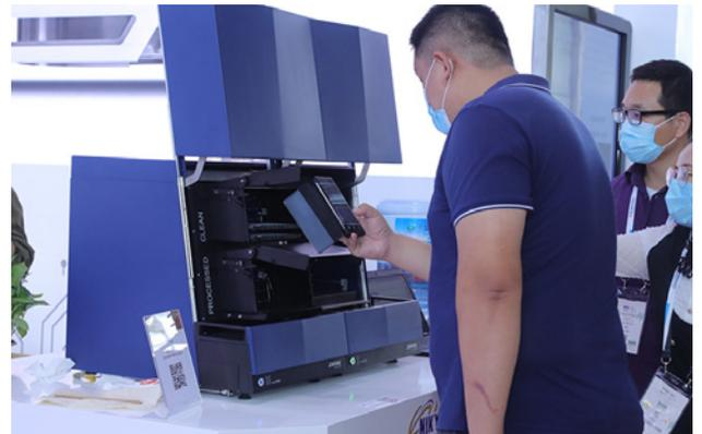
**3. SOTAX TPW 全自动样品制备工作站：**实现样品制备的全流程自动化，将样品称量、添加溶剂、提取、过滤、稀释等功能完全集成，一键即可高效完成多达 200 个样品制备。
